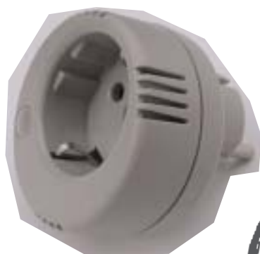
Základní odporová zátěž PTC od německého výrobce Eltako, typ GLA za 16,80 EUR, přes kterou se připojuje spotřebič do sítě
